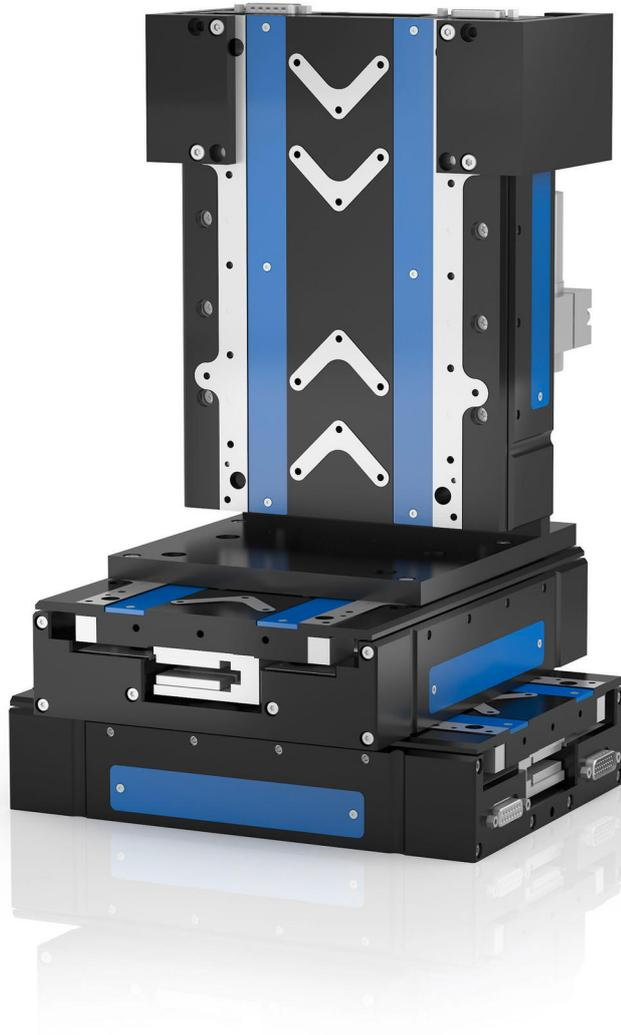
Ein XYZ-Aufbau aus drei V-551 Lineartischen mit jeweils 60 mm Stellweg. Die Z-Achse wurde modifiziert und verfügt über eine magnetische Kompensation der Gewichtskraft.
