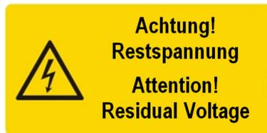
Abbildung 2: Warnzeichen "Restspannung" auf Anschlussstecker des P-5x7/P-5x8
