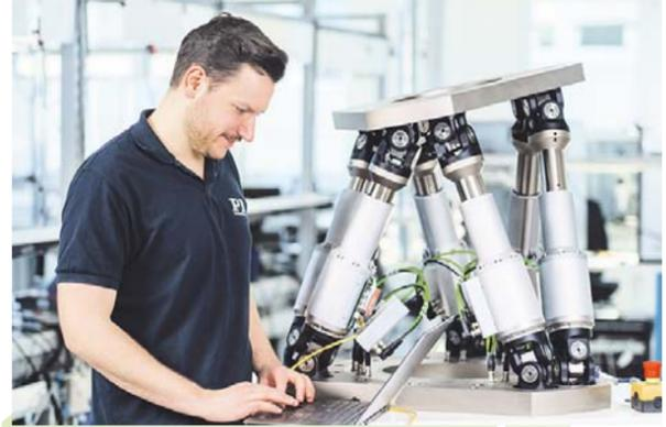
**Hexapoden** wie diesen baut PI für hochpräzise Positionierungsaufgaben. Darüber hinaus entwickelt das Unternehmen weitere Produkte auf Basis von Piezokeramik. Foto: Physik Instrumente
