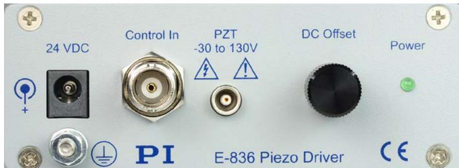
Abbildung 1: Piezoverstärker E-836.1G, Vorderansicht
