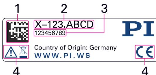
Abbildung 1: Typenschild des P-845.xxV
