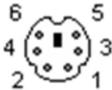
Figure 12: Joystick connector: Mini DIN 6 (f)
