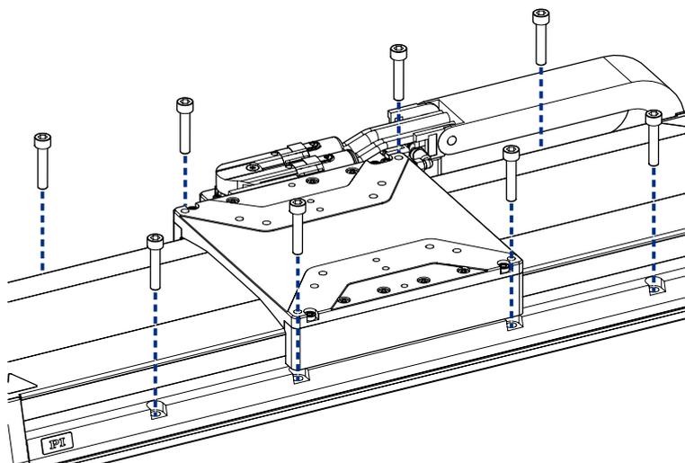
Abbildung 6: Montage des V-412.xx6025E1 auf einer Unterlage
