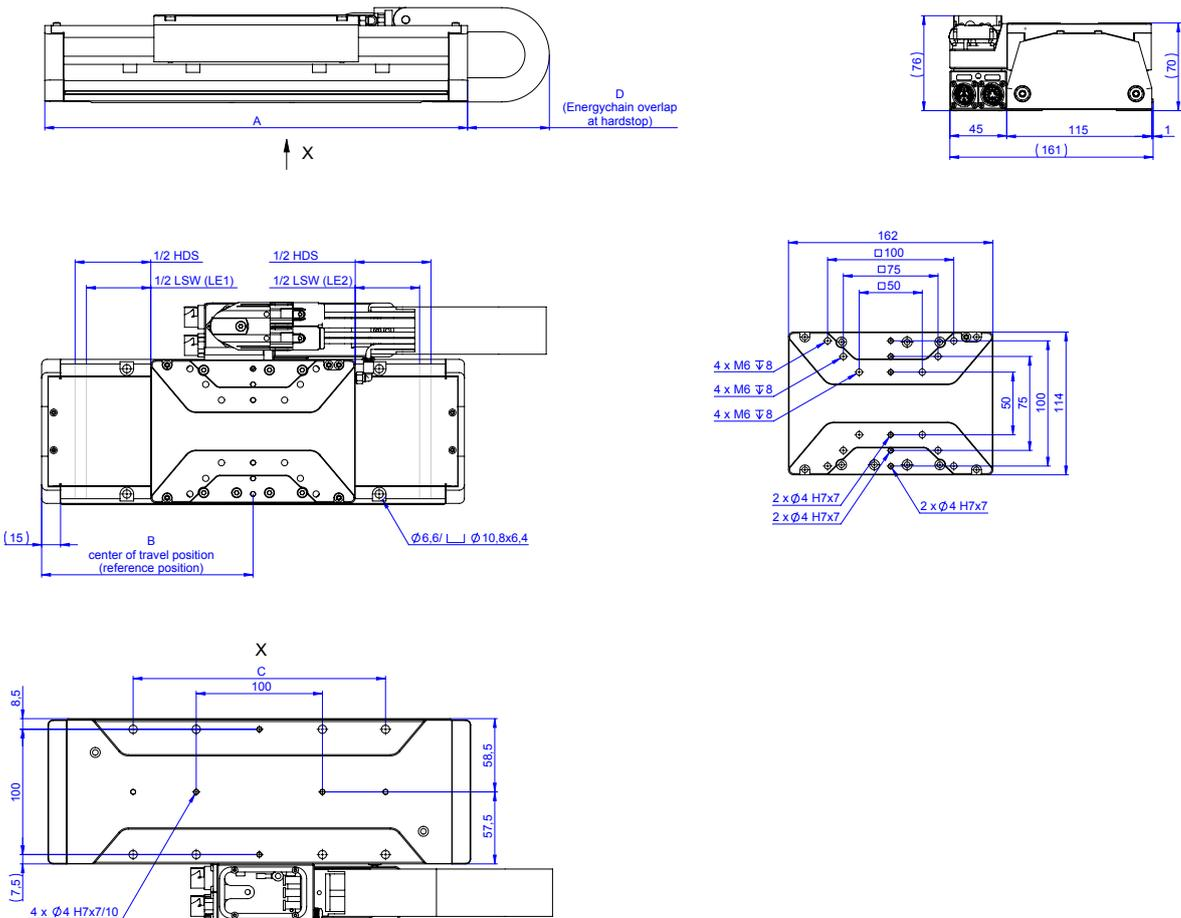
Abbildung 12: Abmessungen des V-412.xx6025E1
