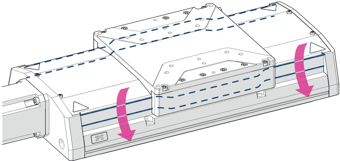
Der passive Staubschutz besteht aus Abdeckbändern, die die seitlichen Öffnungen am Grundkörper des V-412.xx6025E1 verschließen und so das Eindringen von Staub reduzieren.
