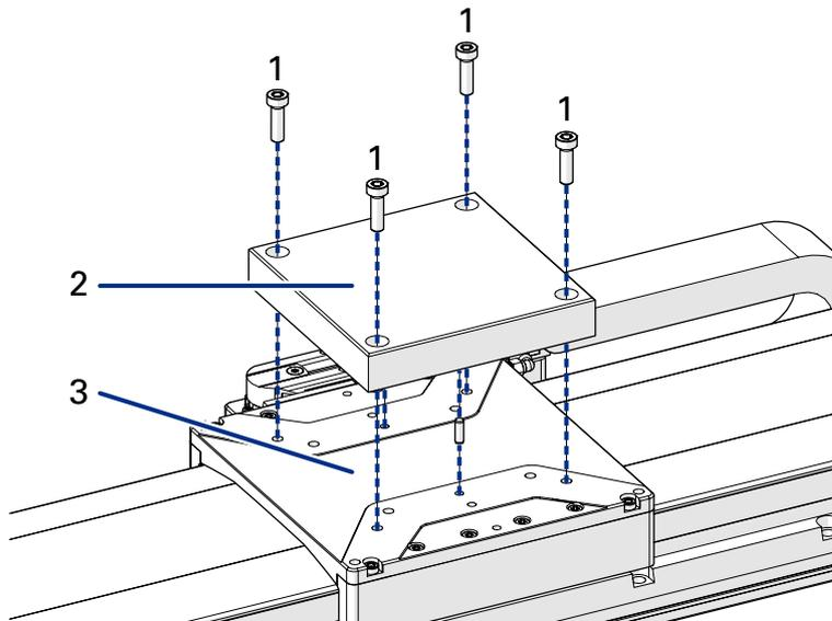
Abbildung 8: Montage der Last am V-412.xx6025E1
