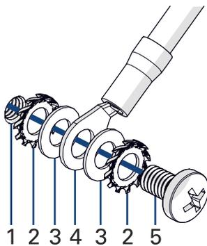
Abbildung 7: Schutzleiteranschluss am V-412.xx6025E1
