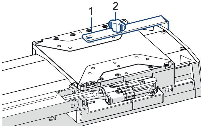
Abbildung 9: V-412.xx6025E1 mit Transportsicherung
