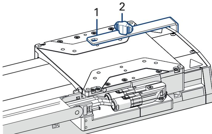
Abbildung 5: V-412.xx6025E1 mit Transportsicherung
