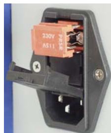
Abbildung 4: Lage der Netzsicherungen und des Trägers, nur eine von zwei Sicherungen ist sichtbar
