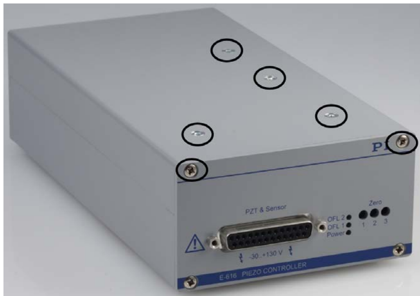
Abbildung 4: Entfernen des Gehäusedeckels über die sechs angezeigten sowie zwei rückwärtige Kreuzschlitzschrauben
