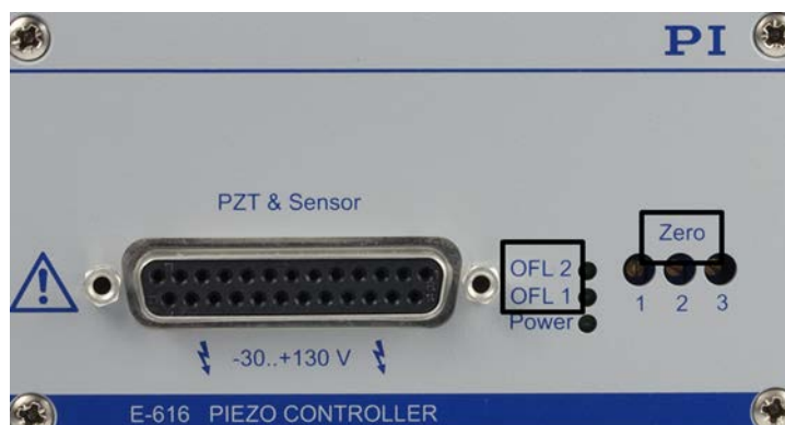
Abbildung 6: Potentiometer Zero 1 bis Zero 3 für den Nullpunktabgleich, sowie OFL-LEDs
