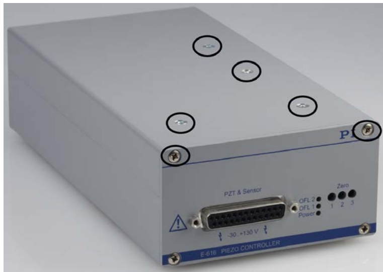
Abbildung 7: Entfernen des Gehäusedeckels über die sechs angezeigten sowie zwei rückwärtige Kreuzschlitzschrauben
