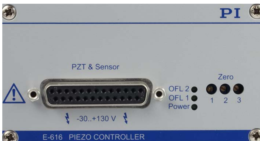
Abbildung 2: Frontplatte des E-616-Tischgeräts
