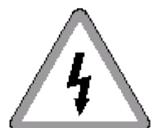
Trennen Sie das Gerät von der Stromquelle, wenn Sie das Gehäuse öffnen und wenn Sie interne Schalter oder Jumper zurücksetzen.
