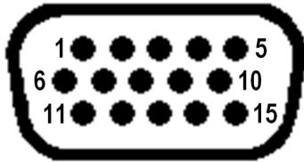
Abbildung 11: Stecker HD D-Sub 15 (m) für den Antrieb, Verbindungsseite
