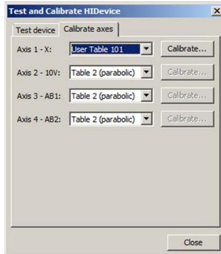
Im Beispiel in der Abbildung wurde der Achse des angeschlossenen Joysticks C-819.20 eine benutzerdefinierte Lookup-Tabelle zugewiesen. Den Achsen 2 bis 4 ist jeweils die vordefinierte parabolische Lookup-Tabelle zugewiesen.
