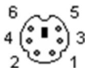
Abbildung 30: Draufsicht der Mini-DIN-Buchse
