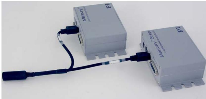
Abbildung 31: Y-Kabel C-819.20Y für Joystick mit 2 Controllern
