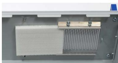
Abbildung 14: Luftfilter, bereits verschoben, und Lüftungslöcher des C-887
