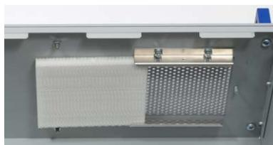
Abbildung 12: Luftfilter, bereits verschoben, und Lüftungslöcher des C-887
