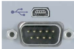
Abb. 21: Mini-USB-Anschluss, Typ B (oben) und RS-232-Anschluss, D-Sub, 9-polig (unten)
