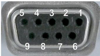
Abbildung 4: Digitales Schnittstellenmodul C-885.iD: D-Sub 9 (weiblich)
