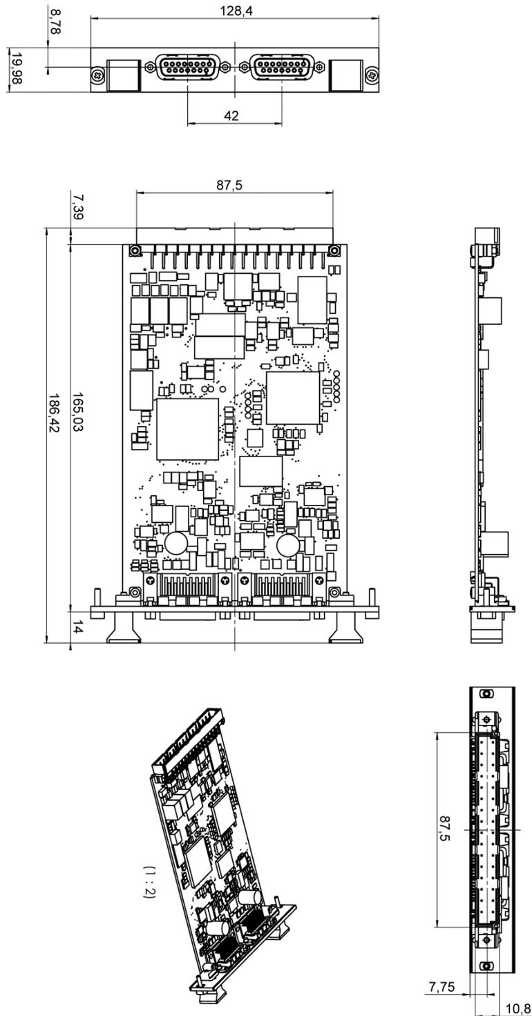
Abbildung 2: Abmessungen des C-863.20C885
