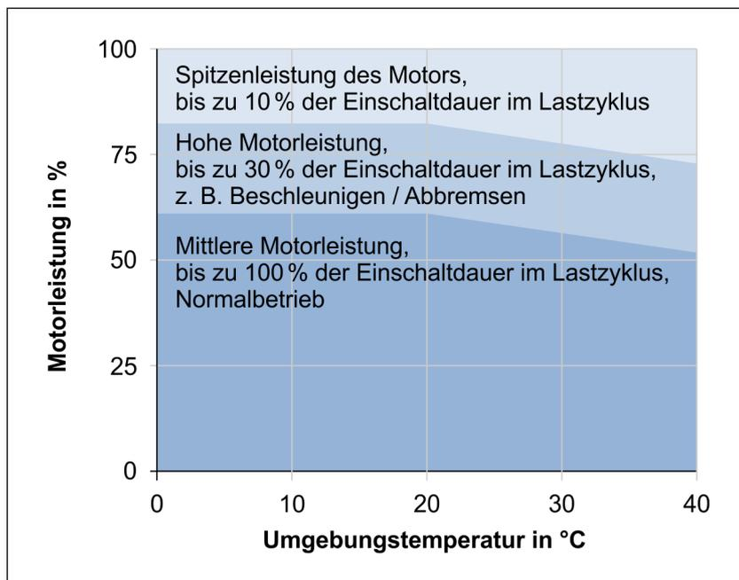
Abbildung 9: U-628: Empfohlene Einschaltdauer und Motorleistung in Abhängigkeit von der Umgebungstemperatur
