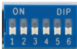
Abbildung 6: DIP-Schalter 1 bis 6: Schalter oben = EIN; Schalter unten = AUS
