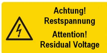
Abbildung 3: Warnzeichen "Restspannung" auf Anschlussstecker des P-545: Hinweis auf Stromschlaggefahr (S. 5)
