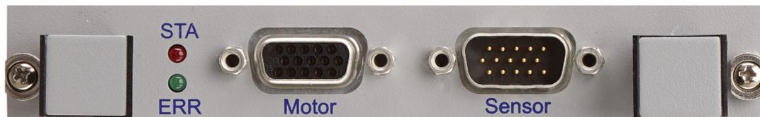
Abbildung 1: Controller-Modul E-861.11C885 (Vorderansicht)
