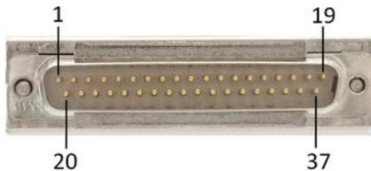
Abbildung 17: Piezo- und Sensoranschluss, D-Sub 37 (m)
