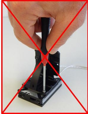
Abbildung 7: Falsche Montage: Drehmomente an der Bewegungsplattform beschädigen den Positionierer
