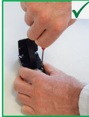
Abbildung 8: Korrekte Montage: Bewegungsplattform festhalten, um Drehmomente auf die Bewegungsplattform zu vermeiden
