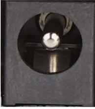
Abbildung 21: Netzteilanschluss: Hohlstecker-Buchse
