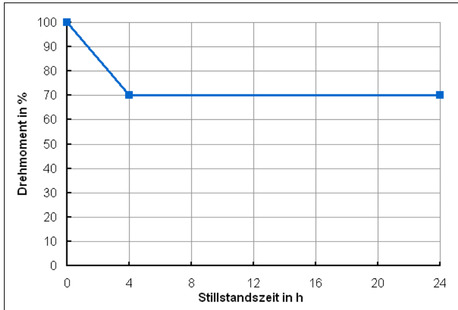
Abbildung 10: Drehmoment des U-651 in Abhängigkeit von der Stillstandszeit des Motors
