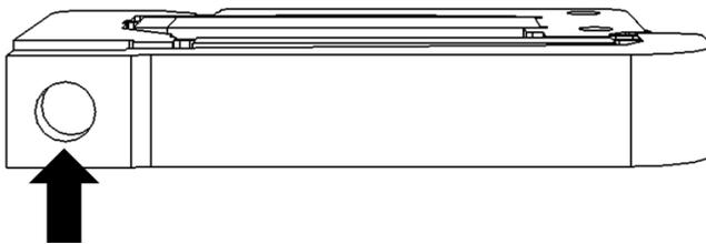
Abbildung 5: Bohrung zur Befestigung einer Last am bewegten Teil
